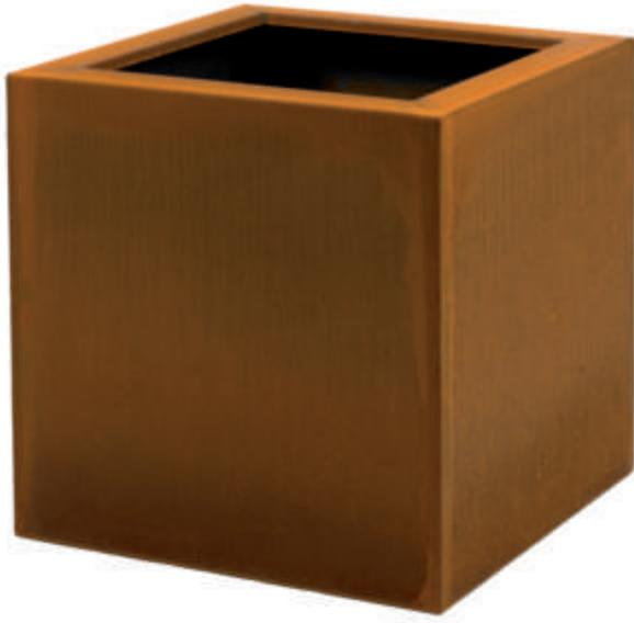
Deze plantenbakken zijn geproduceerd van zogeheten Cortenstaal, wat de eigenschap heeft om in een aantal weken de gehele oppervlakte van de bak te voorzien van een roestlaag. Na een periode van ongeveer 6 tot 8 weken is dit proces voltooid en zal de plantenbak niet verder gaan oxideren. Let wel op! In de eerste weken kan de bak nog roestvlekken afgeven.
